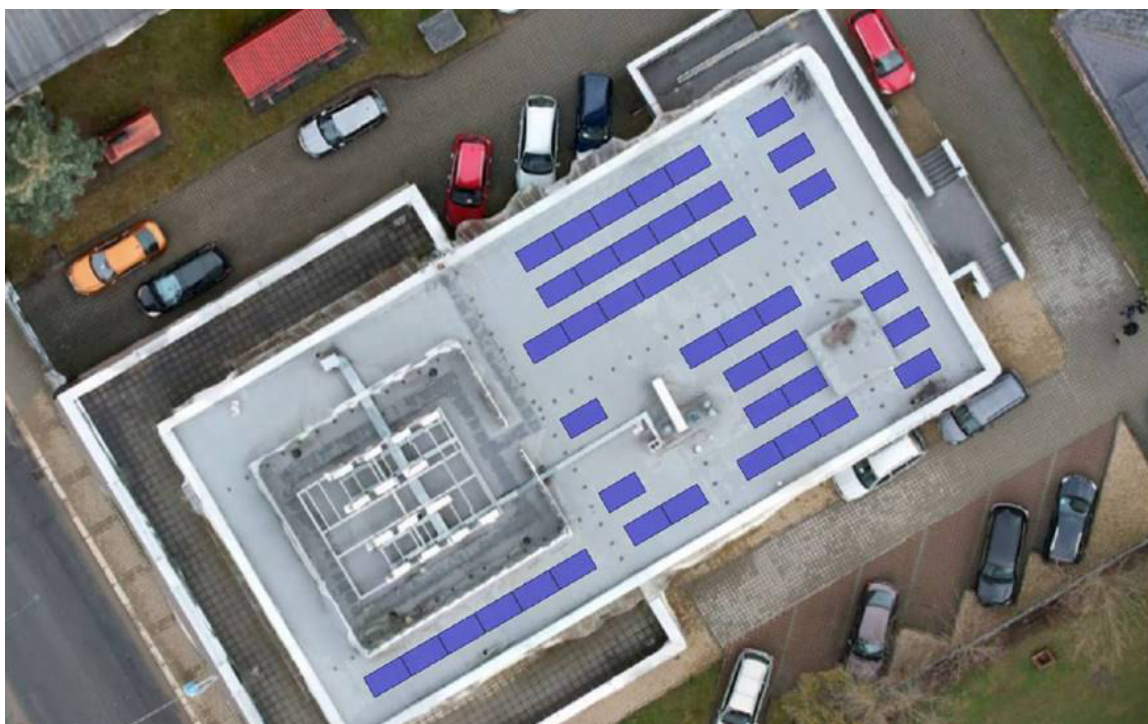
Střecha budovy „D“ s návrhem umístění FVE panelů
