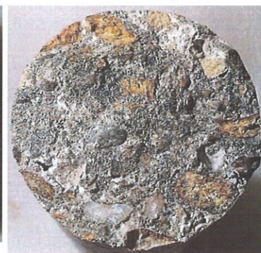
Obr. 10: vývrt V3 – koncová lomová plocha
