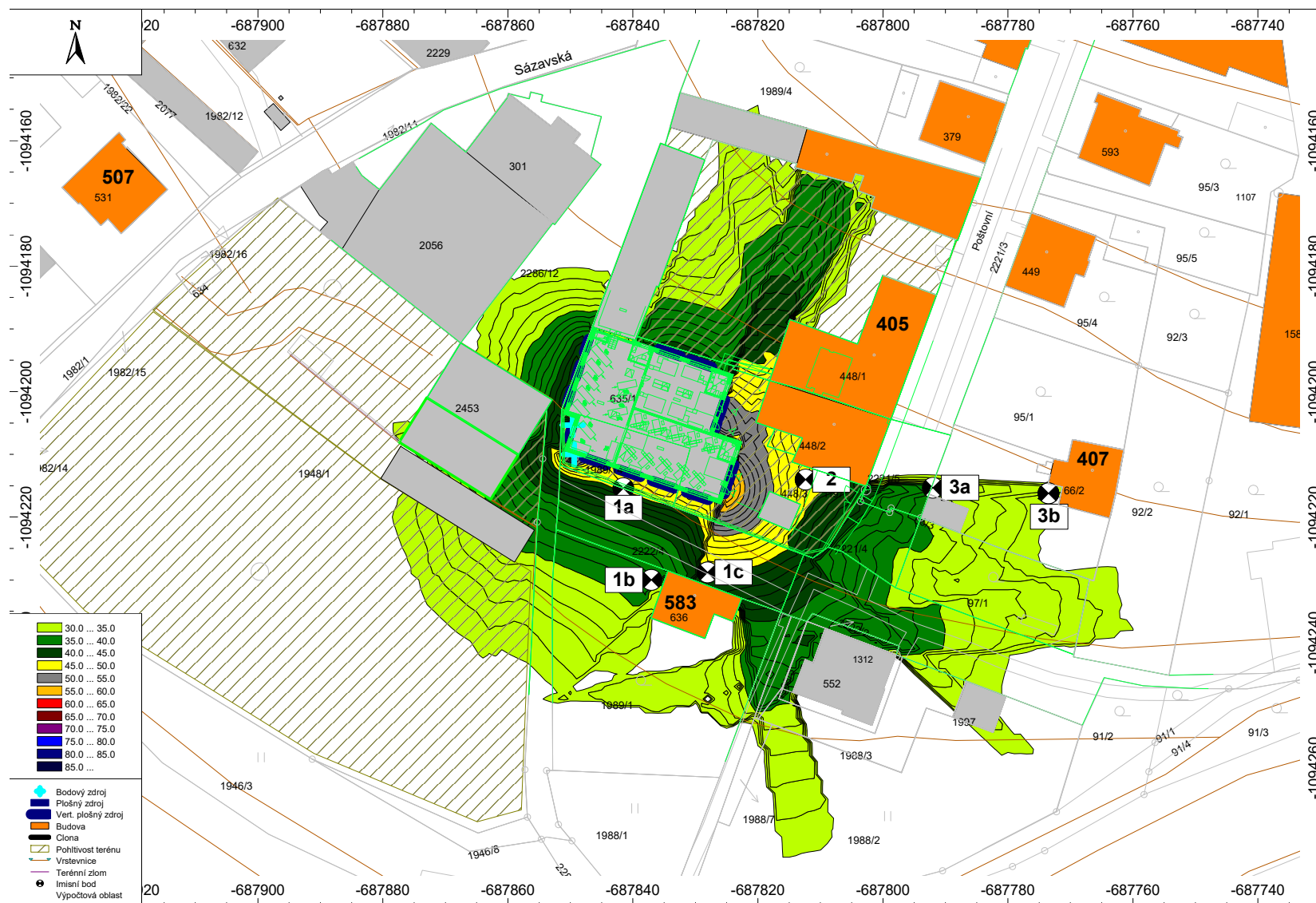
PŘÍLOHA II Hluková pásma ve výšce 5 m nad terénem, zdroj hluku: stacionární zdroje - přístavba, DEN
