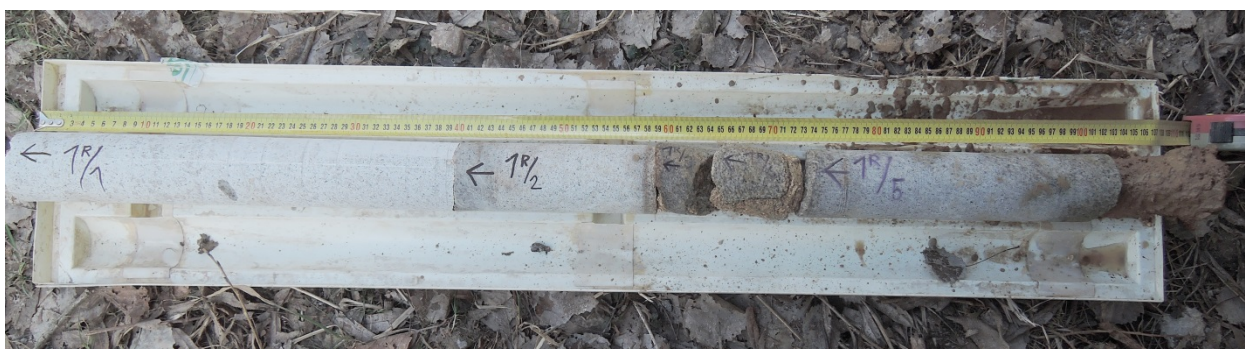
Obrázek č. 2: Odebrané jádro 1R (šipky ukazují k lici konstrukce).
