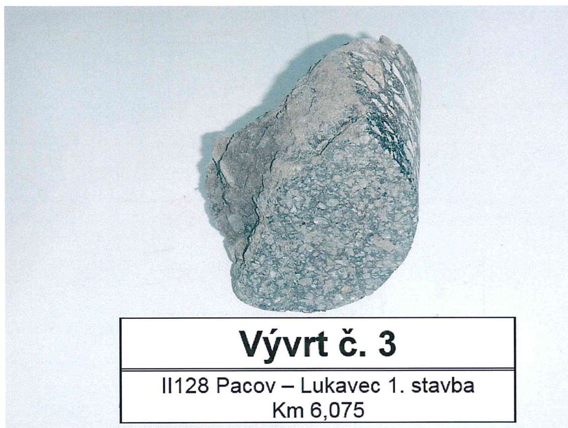
Foto č. 4 – Detail vývrtu č. 3
