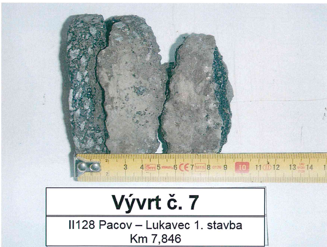
Foto č. 8 – Detail vývrtu č. 7
