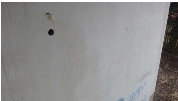
Foto 7.1.1 Pohled na provedené místo jádrového vývrtu Ø75 mm s označením V-06 odebraného z dřívku pilíře P2 v pohledu od opěry OP3 ve výšce 2300 mm od horní hrany ÚP
