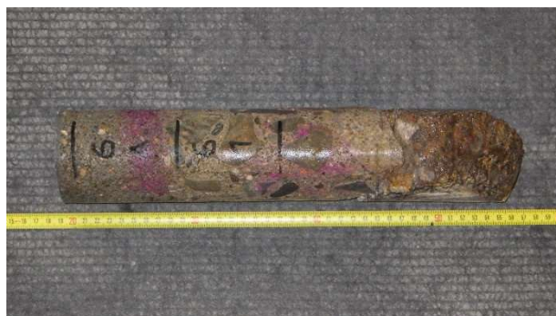
Foto 7.1.4 Laboratorní foto vzorku s označením V-06 včetně provedeného testu hloubky karbonatace a s vyznačenou polohou zkušebních těles
