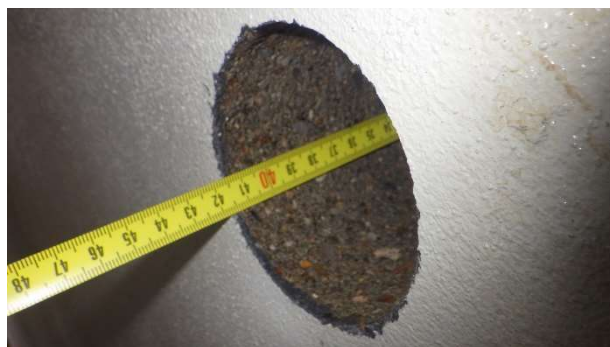
Foto 7.1.2 Měření celkové hloubky provedeného jádrového vývrtu Ø75 mm s označením V-06 odebraného z dřívku pilíře P2 v pohledu od opěry OP3 ve výšce 2300 mm od horní hrany ÚP
