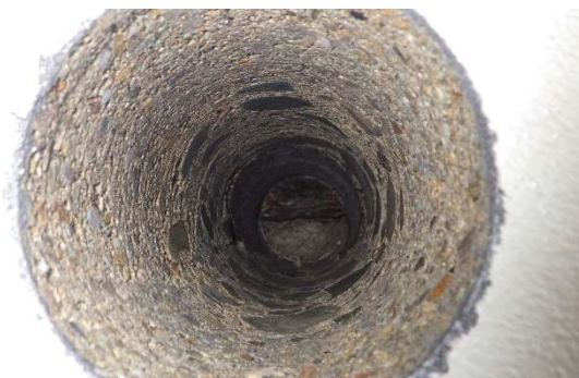
Foto 7.1.3 Detailní pohled do ostění po vyjmutí provedeného jádrového vývrtu s označením V-06
