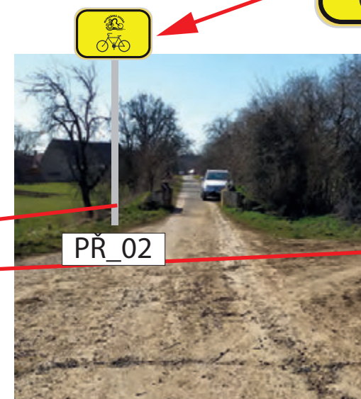
INSTALACE 2x IS21a (MLYNÁŘSKÁ) NA NOVÝ SLOUPEK SPOLEČNÝ PRO OBA SMĚRY V ZEMNÍ BETONOVÉ PATCE POZEMEK: PARC. Č. 665, K. Ú. PŘEŠOVICE (OBEC PŘEŠOVICE)
