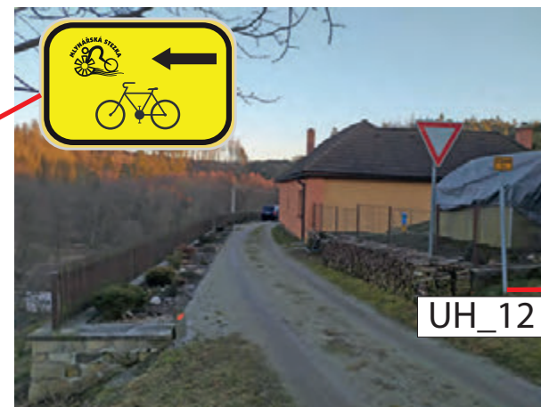
INSTALACE IS21b (MLYNÁŘSKÁ) NA STÁVAJÍCÍM SLOUPKU CYKLOTRASY (5234), UMÍSTĚNÍ POD STÁVAJÍCÍ ZNAČENÍ
