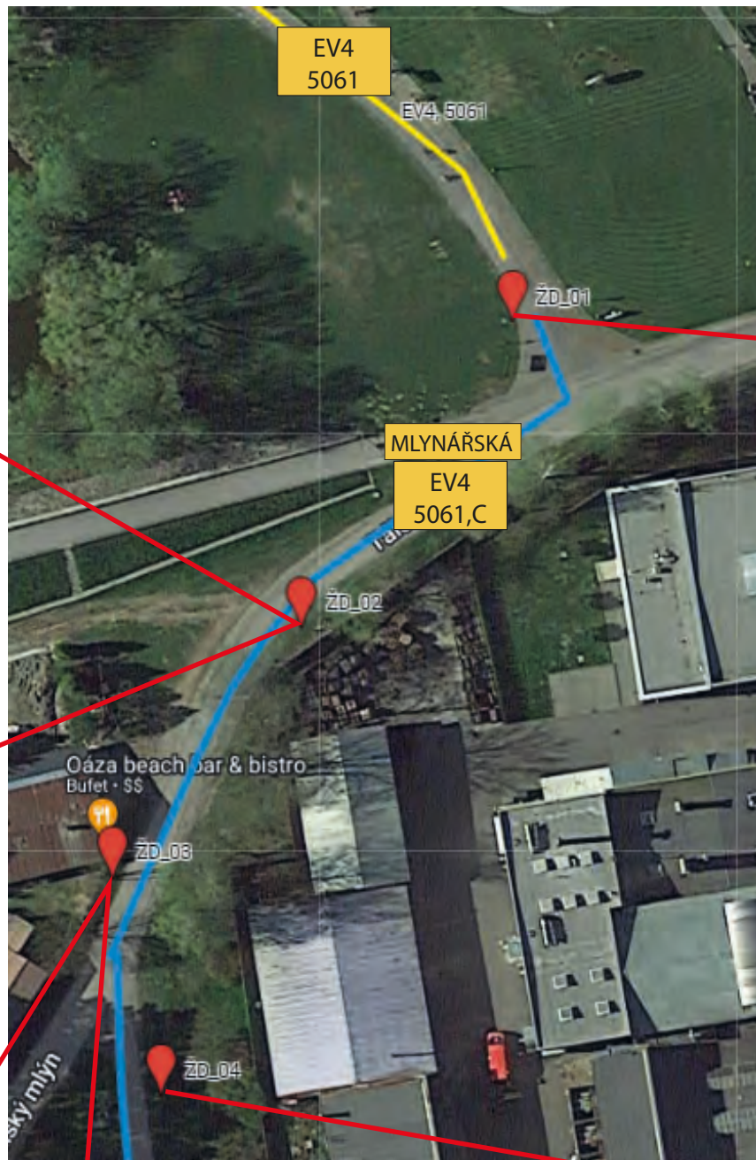
INSTALACE IS19c (MLYNÁŘSKÁ) NA NOVÉM SLOUPKU V KOTEVNÍ PATCE UMÍSTĚNÍ MIN. 10 m PŘED ZNAČKOU DZ C9b KONEC CYKLOSTEZKY POZEMEK: PARC. Č. 650/1 K. Ú. ZÁMEK ŽDÁR, (MĚSTO ŽDÁR NAD SÁZAVOU)
