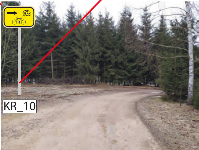
INSTALACE IS21a (MLYNÁŘSKÁ) A IS21c (MLYNÁŘSKÁ) NA NOVÝ SPOLEČNÝ SLOUPEK PRO OBA SMĚRY V KOTEVNÍ PATCE POZEMEK: PARC. Č. 697/6, K. Ú. KRÁSNĚVES, (OBEC KRÁSNĚVES)
