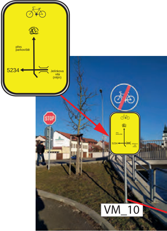
INSTALACE NOVÉ IS20 (MLYNÁŘSKÁ + 5234) NA STÁVAJÍCÍM SLOUPKU POD DZ C8b
