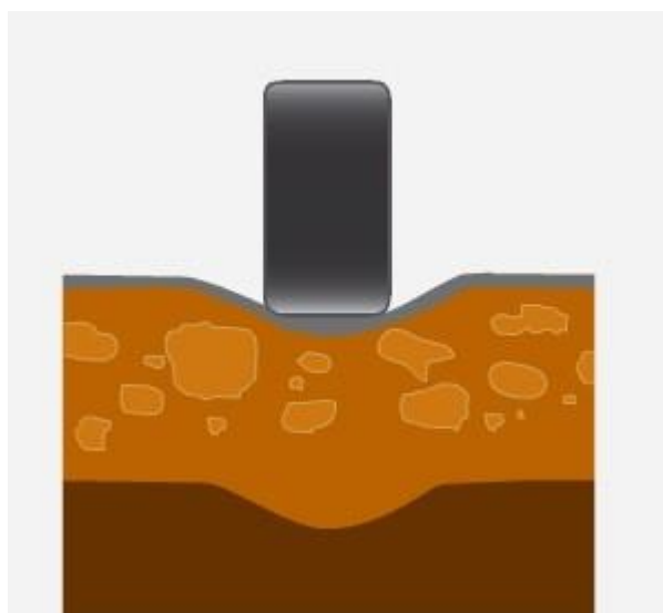
Obrázek 10. Riziko vzniku kolejí typu 2.
