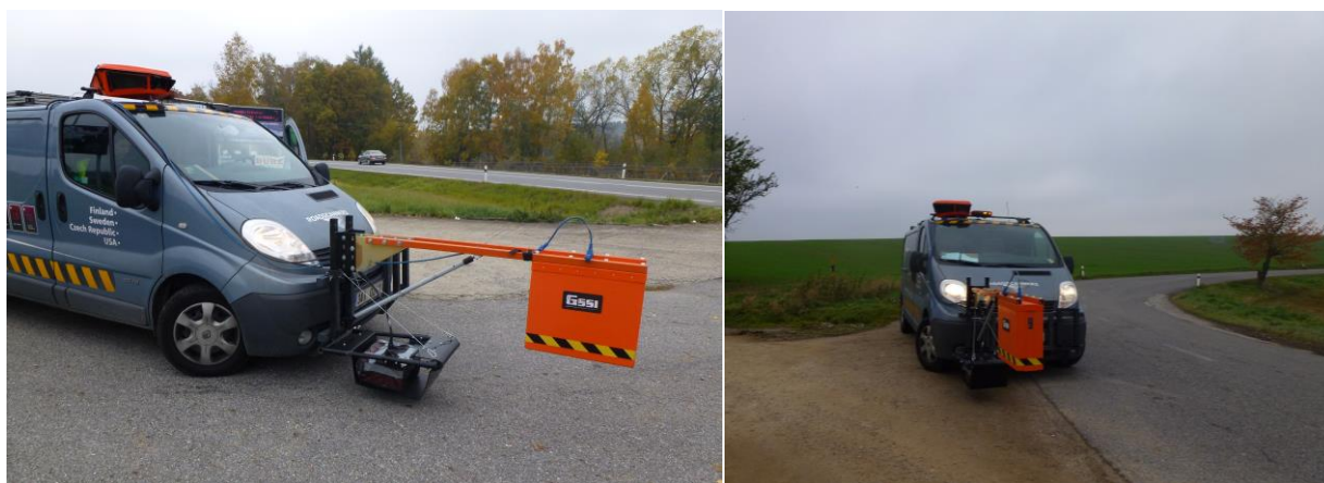
Obrázek 5. GPR měřicí systém společnosti Roadscanners CE vybavený 2 GHz “horn” anténou a 400 MHz anténou před vozidlem. Videokamera s GPS přijímačem je upevněna na střeše vozidla.
