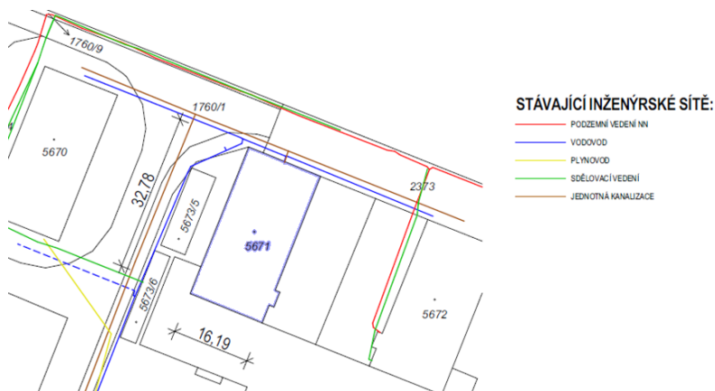
Obr. č. 1 Napojení budovy na technickou infrastrukturu
