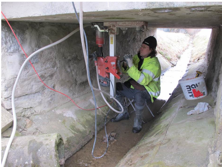
Obr. 4.2: Odběr vývrty z nosné konstrukce mostu – ŽB desky
