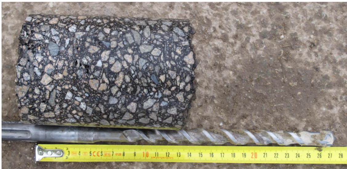
Obr 4.11: Sonda S2, 0 -140 – asfaltový beton, 140 -270 – jílový nános
