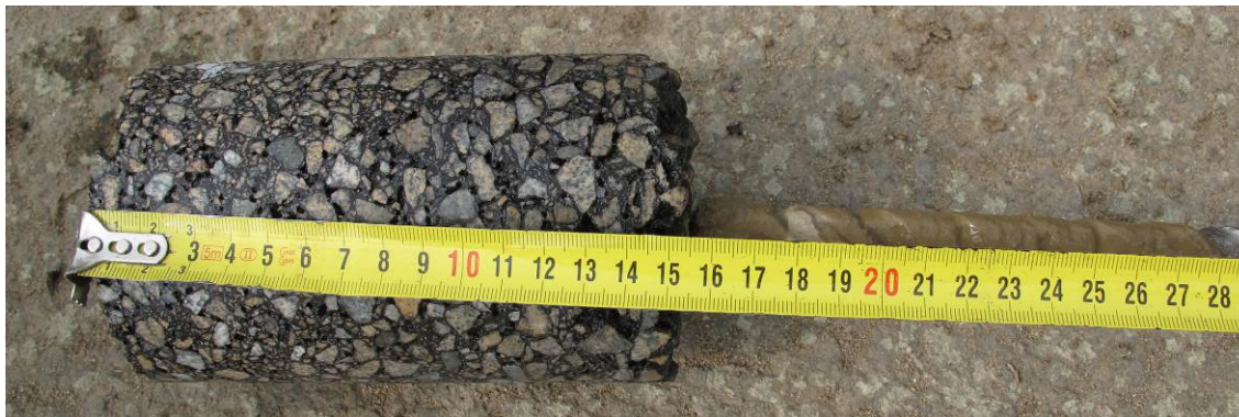
Obr 4.10: Sonda S1: 0 – 150 mm: asfaltový beton, 150 – 280 mm- jílový nános
