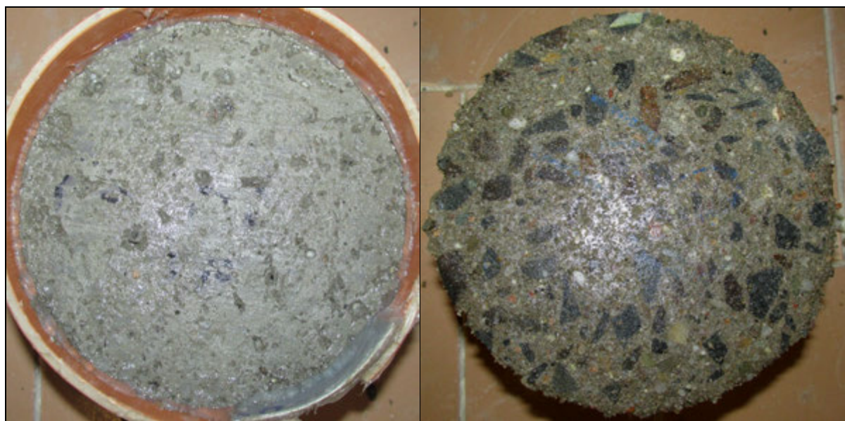
Foto 4: Pohled na čelo a dno vývrtu V3 – po CH.R.L. - metoda C – 100 cyklů
