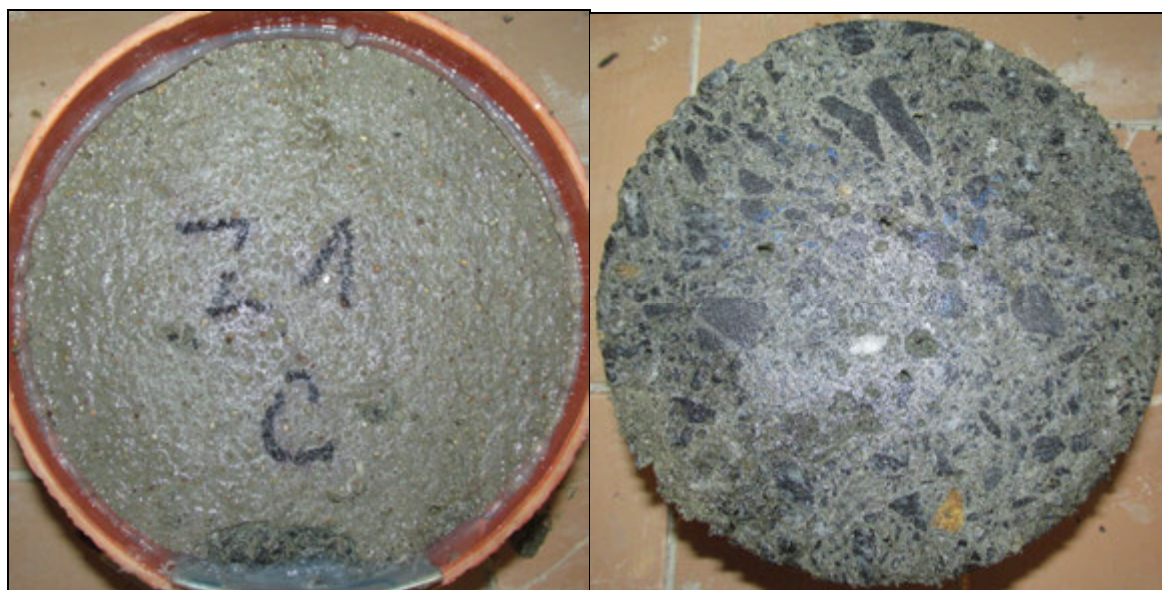
Foto 2: Pohled na čelo a dno vývrtu V1 – po CH.R.L. - metoda C – 100 cyklů
